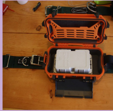
Perseguidor GPS de AbeewayTM habilitado por LoRa en una caja Pelican resistente al agua
